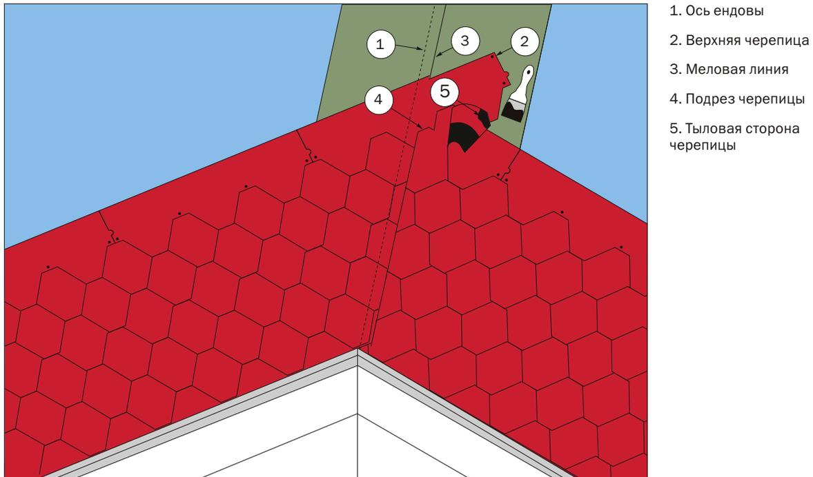
Рис. 31. Ендова кровли
