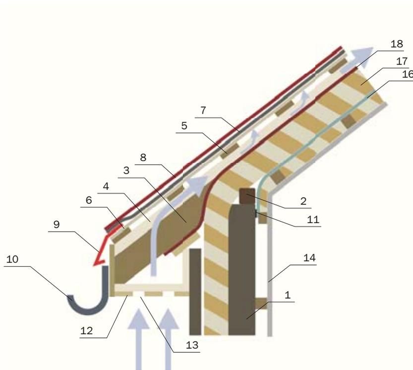
Рис. 18. Принципиальная схема устройства притока наружного воздуха через карниз
